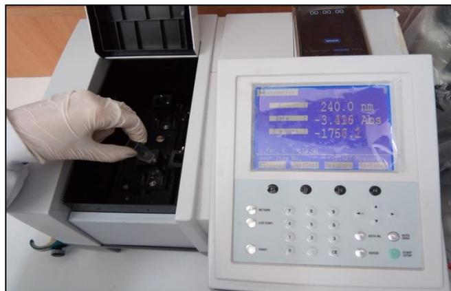
**Photo 8 :** Spectrophotomètre UV et visible.
